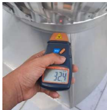
Gambar 4. Pengujian Kecepatan Turbin Di Luar Ruangan
