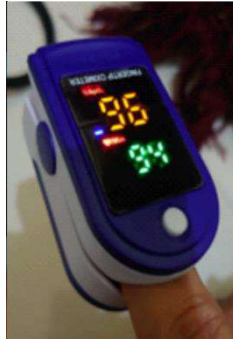
Gambar 7. Fingertrip Pulse Oximeter sebagai Validator
