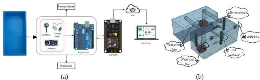
Gambar 1 Perancangan sistem : (a) Desain Sistem e-fishery ; (b) Skema Petelakkan Sensor dan Komponen Pendukung.
