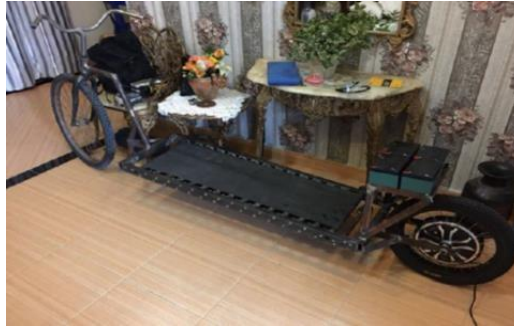
Gambar 1. Sepeda Treadmill dengan Sistem Penggerak Motor BLDC [5]
