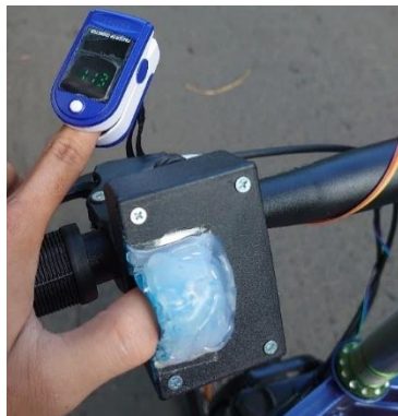
Gambar 8. Pengujian Sensor MAX30102 dan Validator dengan Mengendarai Sepeda Treadmill
